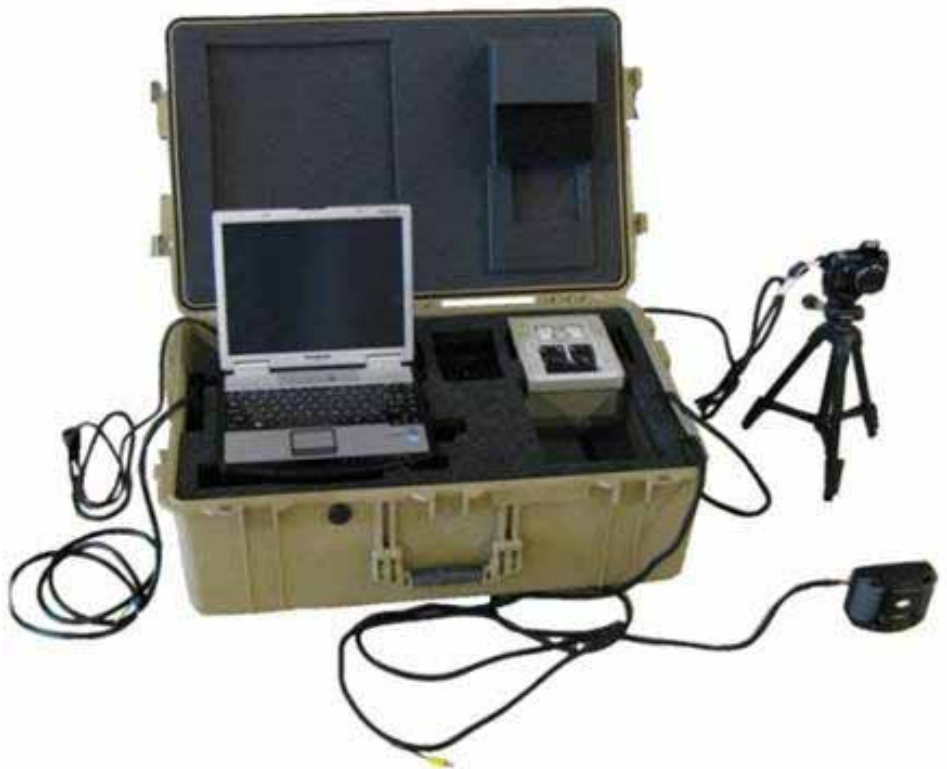
Afbeelding 13: De BIMA beschikt over een fotocamera, irisscan en een scanner voor vingerafdrukken. Deze zijn aangesloten op een computer.
