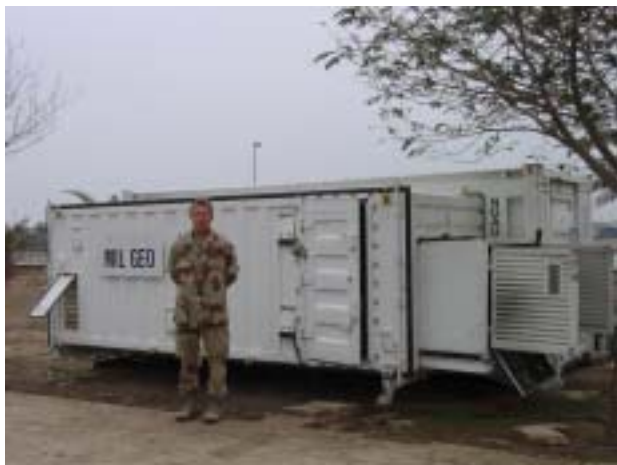
Afbeelding 6: een voorbeeld van een uitschuifbare GIS container. De vloeroppervlakte wordt hierdoor bijna verdrievoudigd.
