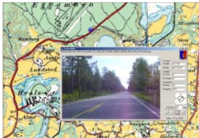
Afbeelding 7: een voorbeeld van een digitale fotocamera met geïntegreerde GPS die het mogelijk maakt de foto geografisch te plaatsen in het GIS.
